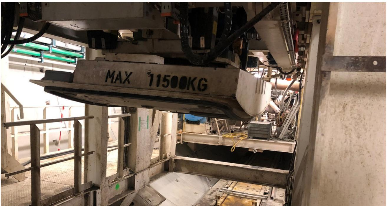
*Abbildung 9: Kran zum Abladen der Tübbinge mittels Vakuumsystem*
