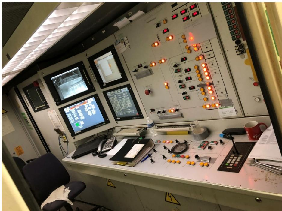
Abbildung 7: Steuerstand der Tunnelvortriebsmaschine
