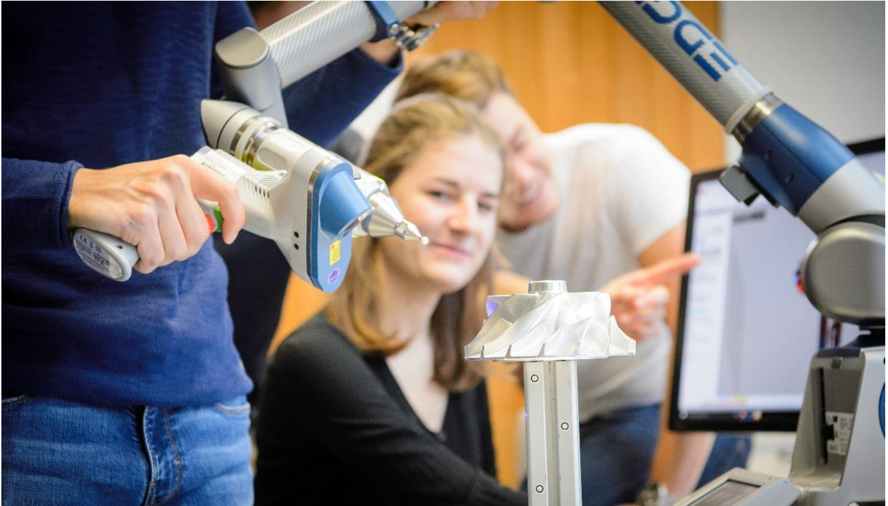
Abbildung 11: Vermessung einer Turboladerturbine
