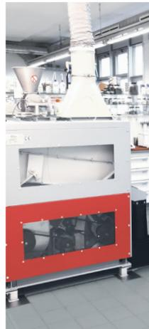
Wendelscheider für die Feinkornsorrierung (nass) von heterogenen Gemischen nach der Dichte Ø 350 mm
