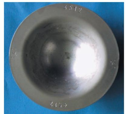
Abb. 3: Ansichtsaufnahme einer tiefgezogenen Probe [Kalotte]
