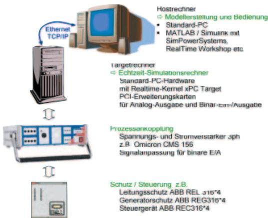
Abb. 7: Komponenten bei der Echtzeitsimulation für eine Schutzrichtung
