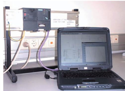
Abb. 3: Hardware-in-the-Loop-Testsystem mit SPS und Simulationsrechner
