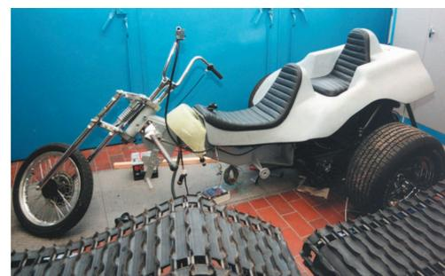
Abb. 1: Straßenversion im Fahrzeuglaboratorium in der Aufbauphase
