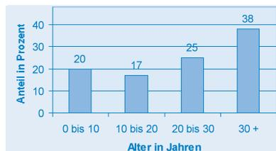
Abb. 2: Altersstruktur der Mittelspannungskabel in Deutschland [1]
