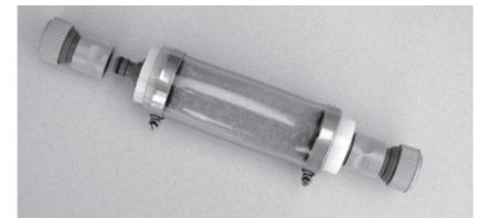
Abb. 7: EINFACHE TROCKNUNGSVORRICHTUNG MIT GARDENA-TEILEN AUS DEM BAUMARKT
