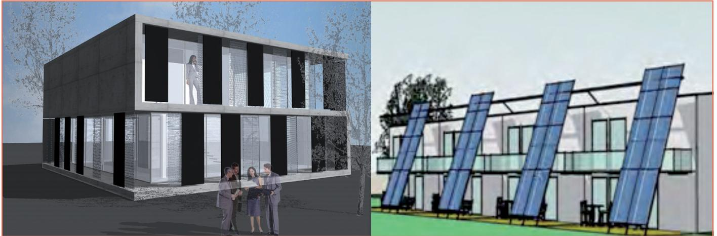
Abb. 3: LINKS: EINFAMILIENHAUS MIT FASSADENINTEGRIERTEN KOLLEKTOREN, RECHTS: SOLARSTRUKTUR VOR REIHENHAUSZEILE
