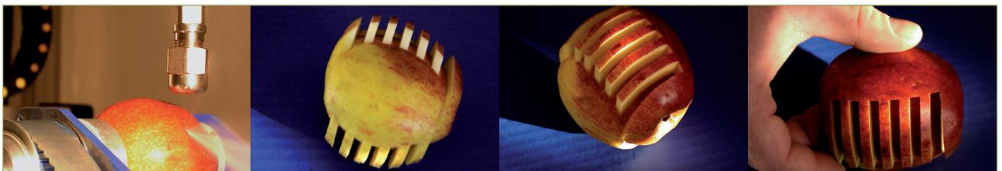
ABB. 6: SCHNITTBEISPIEL DES HOCHDRUCKWASSERSYSTEMS
