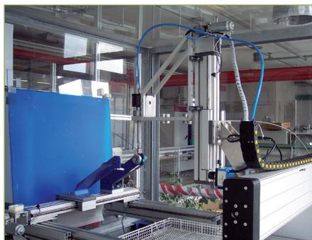
stand, Wasserdruck sowie Drehwinkel der Frucht wird durch einen Hochleistungs-PC realisiert.
