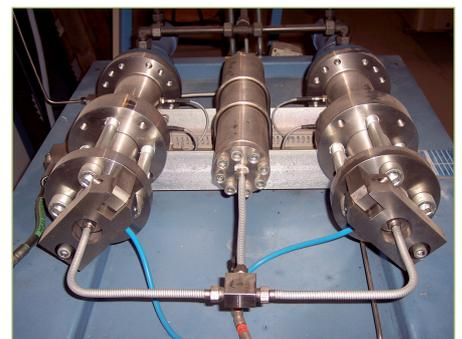
Abb. 3: DRUCKÜBERSETZER DER HOCHDRUCKPUMPE
