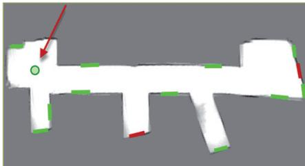
ABB. 10: ALLE EBENERDIGEN TÜREN IM FLÜGEL DES UG WURDEN ERKANNT (GRÜNE LINIEN)
