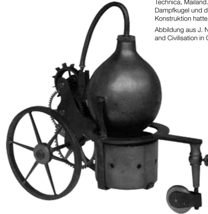
» Bereits vor drei Jahren, als ich die Kräfte der Dampfkugel untersuchte, ließ ich einen zwei Schritt langen Wagen aus leichtem Holz herstellen, der auf vier Rädern leicht beweglich war. In seine Mitte stellte ich ein Gefäß mit brennenden Kohlen, und darauf setzte ich die Dampfkugel [...]
