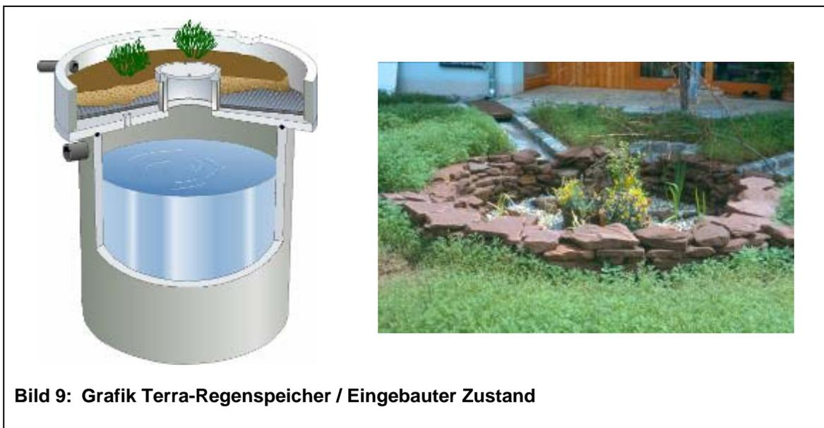
**Bild 9: Grafik Terra-Regenspeicher / Eingebauter Zustand**
