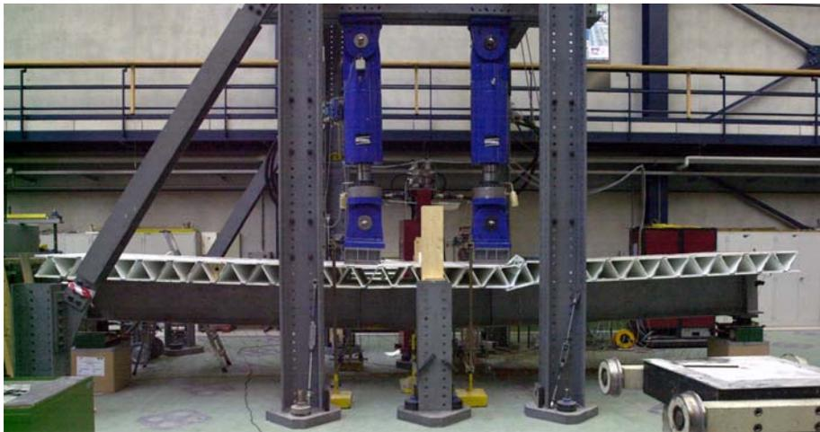
Bild 5: Versuchsträger aus [5] mit geklebter Fuge zwischen Stahlträger und Fahrbanhplatte (keine mechanischen Verbindungsmittel) nach aufbringen der Bruchlast.
