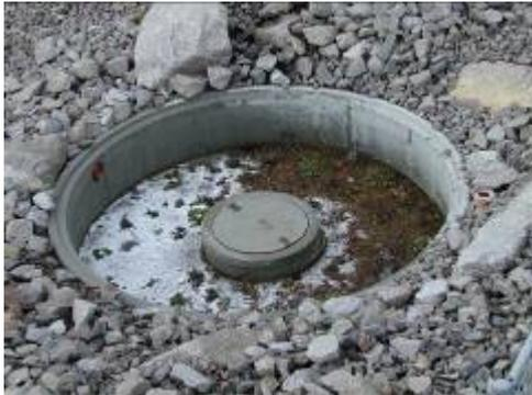
**Bild 12: Versuchsanlage Terra-Regenspeicher mit Eislinnenbildung**
