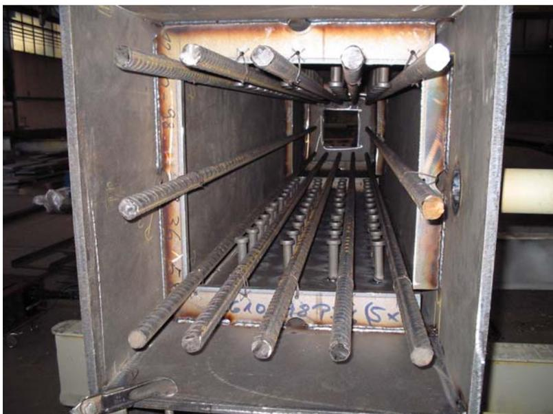
Bild 7: Querschnitt Mittelgurt mit Kopfbolzendübeln
