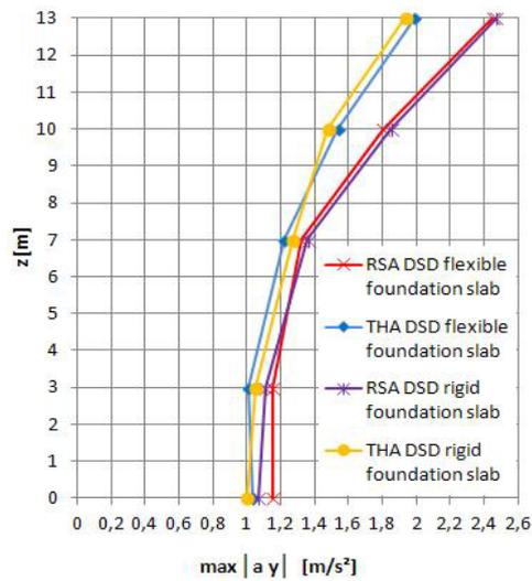
(d) Accelerations, model with 5% damping
