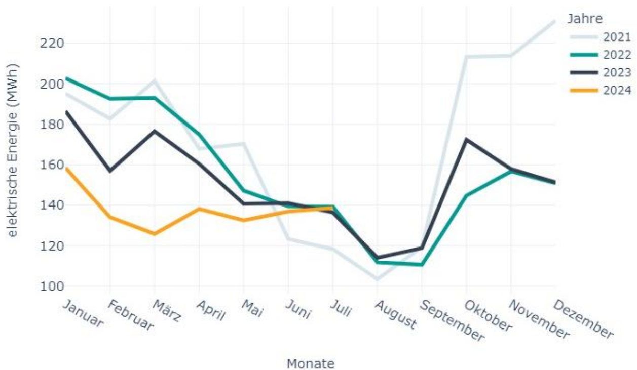
Abbildung 7: Monatlicher elektrischer Energiebedarf bis zur letzten Datenübermittlung (= Strombedarf – Einspeisung ins städtische Netz) (Quelle: Eigene Darstellung)
